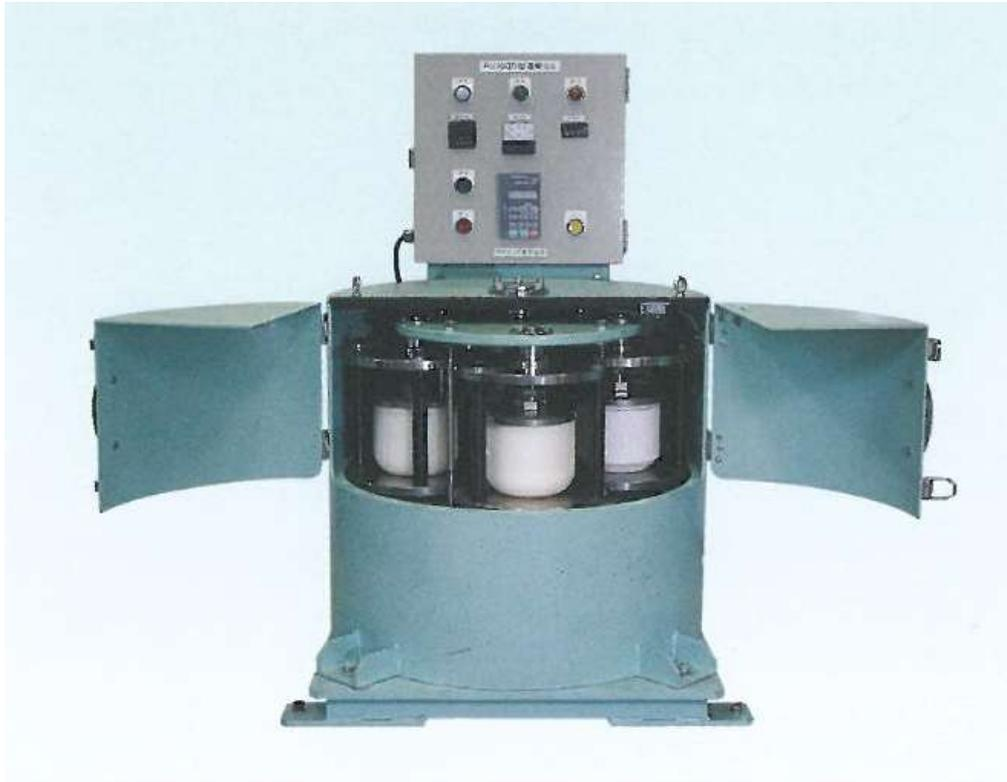
同时考虑做为量产的目的，使用适应于长时间运转作业，使用高质量的机械部件，特别是轴承部分，采用高速耐久性高性能轴承。本机适用的容器及研磨球材质有：氧化铝，MC 尼龙（6N 高纯），氮化硅，炭化硅，金属等。并且粉碎时抑制温度上升的冷却装置可以做为可选部件。
