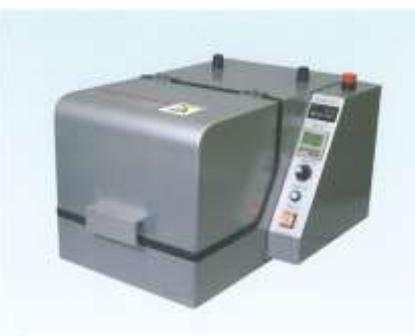
本试验机是在 LP-4 做为标准机的基础上进行设计的小型行星回转球磨装置，按着相同的机械构造及实际运转方式来设计而成。球磨罐的全容量为 45ml，试料的投入量一般控制在约 10ml 以下，对于贵重试料的极少量粉碎比较适用。两球磨罐可同时使用，球磨罐选择完全密封式结构时，湿式的粉碎研
