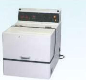
本试验用机是采用行星回转的方式的粉碎设备。适用于从软质到超硬质的试料，脆质到纤维质的试料的粉碎及混合。干式，湿式用途均可使用，短时间内便可以实现均一的亚微米级别的粉碎。公转与自转相结合，利用高离心力对物质进行强有力的粉碎，分散，混合，可以实现很好的作用效果。
